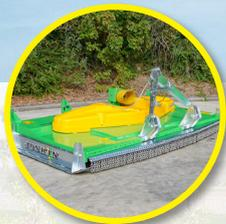
Cubierta en «PMMA» y diseño del bastidor para facilitar la limpieza sin retención de agua
